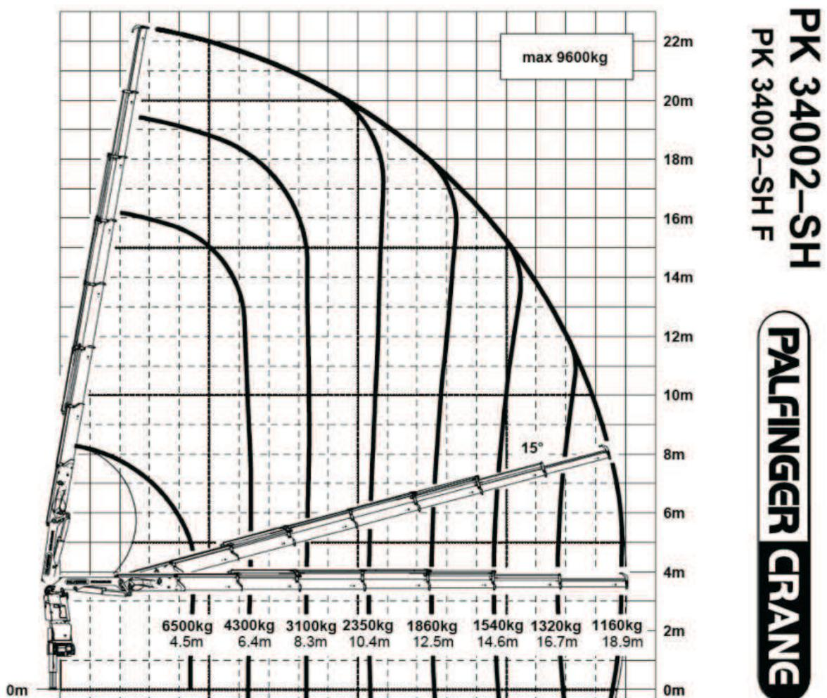
Abstützbreite Standard 5.60 m | Maximal 7.40 m
